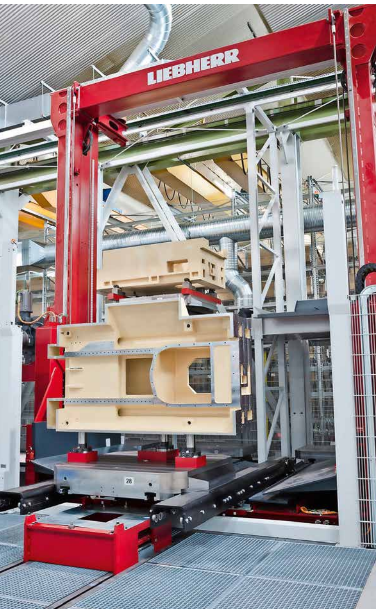
Handling eines Maschinenbettes für eine Verzahnmaschine.
