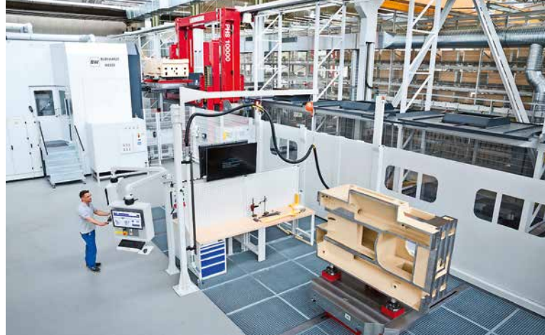
Eines der Bearbeitungszentren von Burkhardt+Weber mit Anbindung an das Liebherr-PHS.
